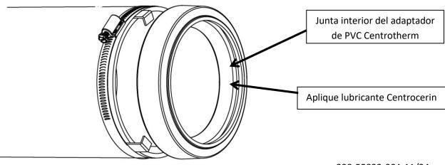
Inserte el extremo macho de la tubería recta o el codo en el extremo con brida y junta del adaptador de PVC. Inserte la tubería o el codo en el adaptador con un movimiento de rotación para que se asiente por completo en la junta interior del adaptador.
