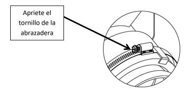
En la conexión de escape de la serie de los modelos comerciales de alta eficiencia, aplique lubricante Centrocerin con el dedo en la junta externa e inserte el adaptador de PVC en el
