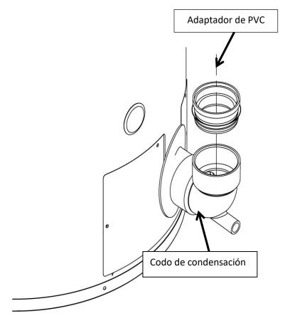
Coloque la abrazadera de combustión Centrotherm alrededor de la parte externa del codo para que los ganchos de sujeción de la abrazadera se acoplen al reborde del adaptador de PVC como se muestra.
