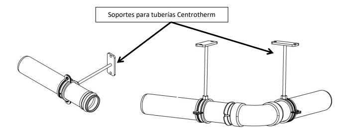
Se deben utilizar anillos de conexión de acero (disponibles a través del proveedor de Centrotherm) en cada unión de la tubería. Los anillos conectores garantizan que las juntas no se separen en caso de cargas pesadas. Estos anillos conectores deben utilizarse para cumplir con los requisitos del estándar ULC-S636. Consulte la siguiente foto con el conector de unión acoplado a las secciones de tubería.
