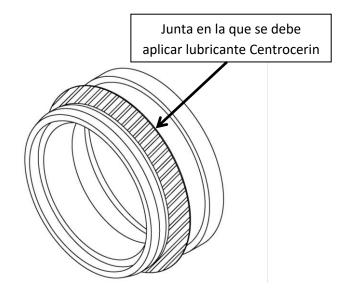
Inserte el extremo macho con junta del adaptador de PVC Centrotherm en el acoplamiento de tubería de PVC.
