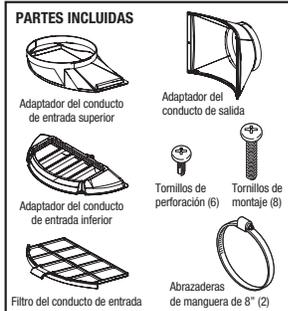
La instalación del kit también requiere: conductos flexibles aislados de 8" (203 mm), soportes colgantes para los conductos y rejillas de ventilación de pared exterior para la entrada y la salida. Se requieren distancias adicionales para los conductos; consulte las instrucciones del kit de conductos.
