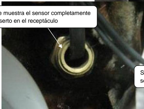
Se muestra el gancho del sensor instalado correctamente
