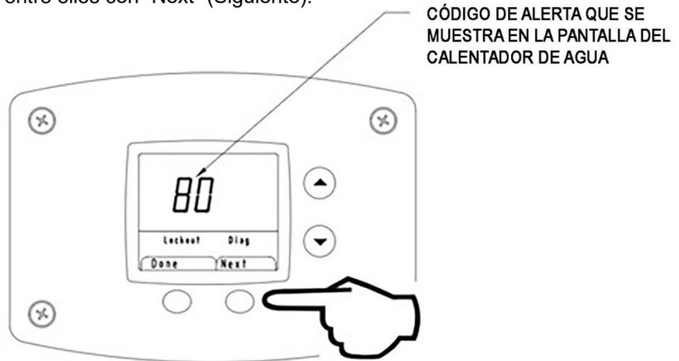
**Paso 5.** Presione “Next” (Siguiete), en la pantalla se muestra “DHW MAX”. Esta es la temperatura máxima permitida que puede alcanzar la unidad antes de que suceda un bloqueo.
