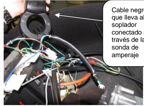
Verificar el voltaje de 120 VCA en el soplador
