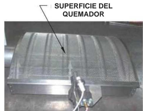
Paso 10. Desatornille el orificio del quemador principal y la línea de alimentación del montaje del distribuidor. Retire el orificio del quemador principal de la línea de alimentación (llave de 1/2"), inspeccione el orificio, y límpielo o reemplácelo si es necesario.
