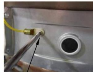
SENSOR DE TEMPERATURA DE LA PUERTA DE LA CÁMARA
