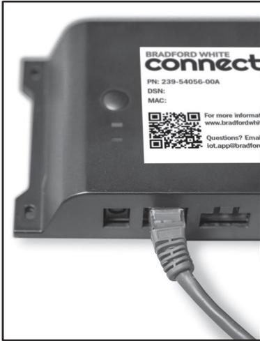
2. Enchufe un extremo del cable ethernet en el puerto RJ45 del adaptador y el otro en el puerto RJ45 del calentador de agua.
