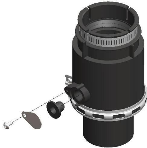
4. Inspecter visuellement le port d'entretien pour s'assurer que le capuchon est correctement installé entre le port d'entretien et le couvercle.
