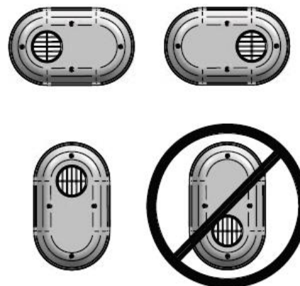
Figure 25 - Orientation d'installation approuvée
