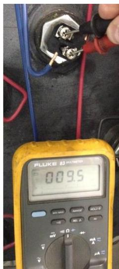
**Figure 14.** Vérification de la résistance de l'élément à l'aide d'un multimètre
