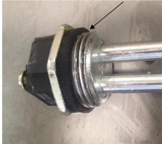
**Figure 7.** Joint d'élément
